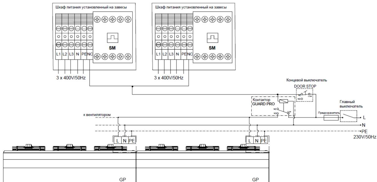
7.4 Схема подключения для GUARDPRO E (электрический нагреватель) С с использованием шкафа управления ControlBox S3 и регулятора скорости SPEEDER S2 или SPEEDER S3
