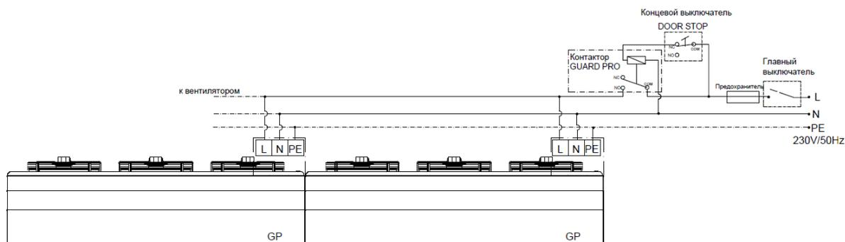
7.2 Схема подключения завес GUARDPRO W и GUARDPRO C с использованием шкафа управления ControlBox S3 и регулятора скорости SPEEDER S2 или SPEEDER S3
